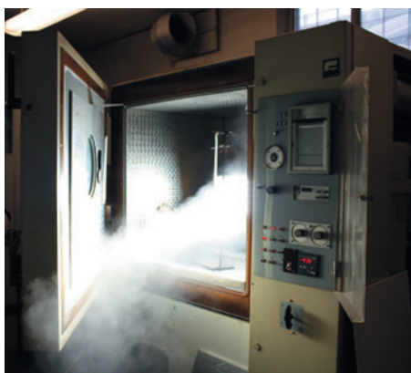
Рис. 3. Камера тепла и холода для климатических испытаний ОП
